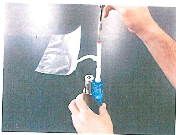
図 3 水素及び酸素の発生ガス採取
